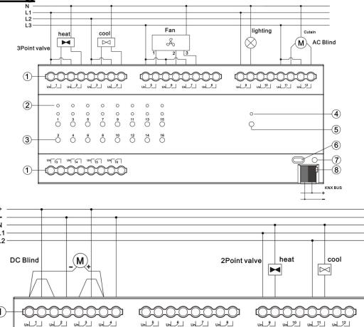
① **Ausgänge, Lastanschluss:** Das abgebildete Symbol zeigt das Schaltprinzip für jeden Kanal an.
