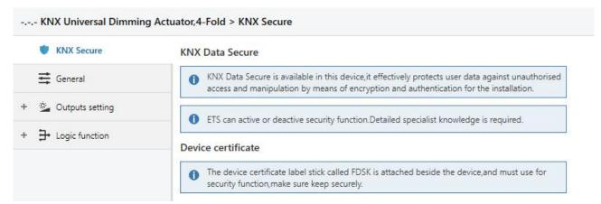
Fig.5.1 (1) "KNX Secure" parameter window
