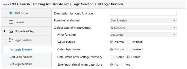
Fig.5.4.5 "Gate function" parameter window
