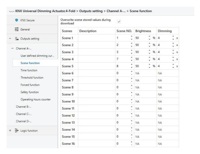
Fig.5.3.3.1 "Scene function" parameter window
