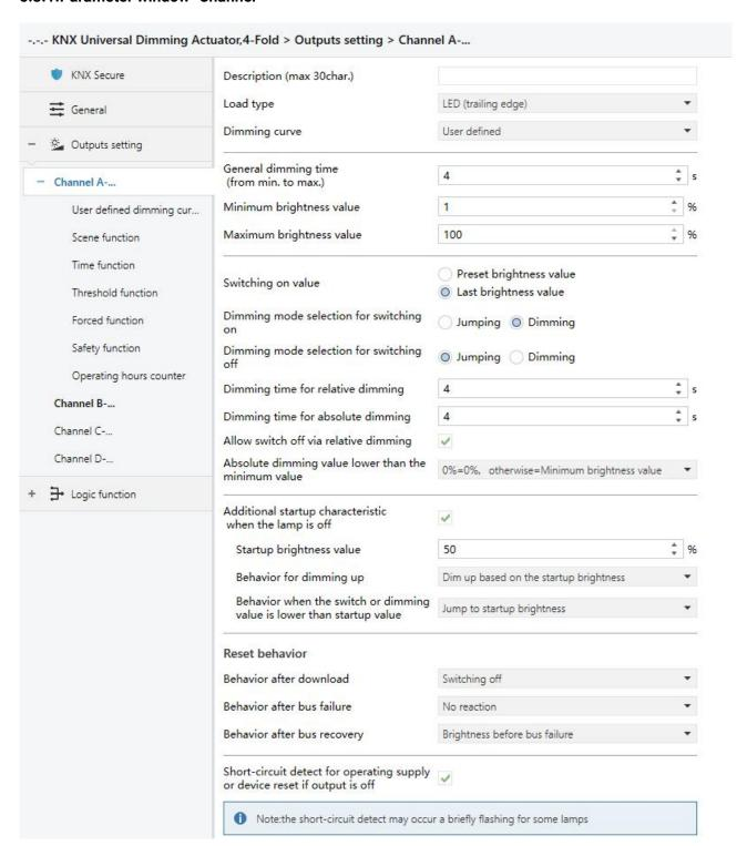
Fig.5.3.1(1) "Channel" parameter window
