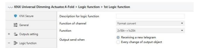
Fig. 5.4.4 "Format convert" parameter window
