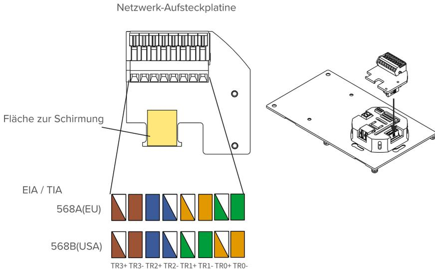
2. Stecken Sie die Netzwerkplatine auf den LAN-Anschluss, wie im Bild rechts gezeigt.
