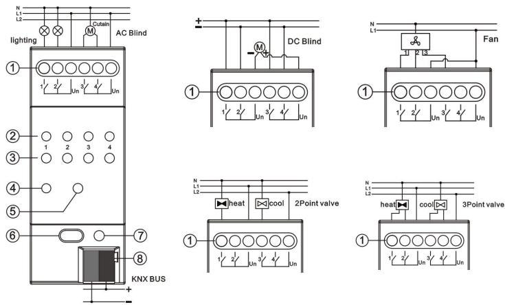
**①Ausgänge, Lastanschluss:** Das abgebildete Symbol zeigt das Schaltprinzip für jeden Kanal an.
