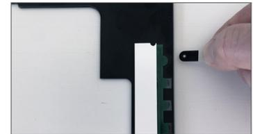
7. Stecken Sie das Flachbandkabel wieder in die Buchse auf der Rückseite des Glasrahmens ein.
