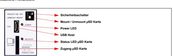
Die Power-LED leuchtet sobald AUX angeschlossen ist. Falls die LED nicht leuchtet, bitte Versorgungsklemme überprüfen. µSD-Karte wird eingesteckt und mittels Schalter gemountet.
